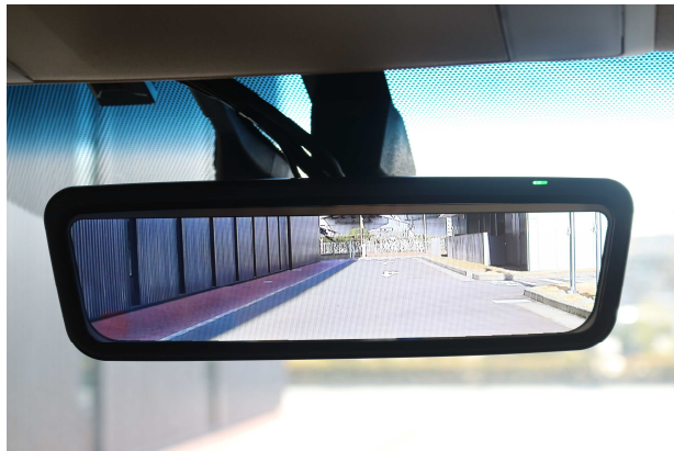
写真:ハイブリッド インナーミラー(実際の採用モデルとは形状が異なります)
